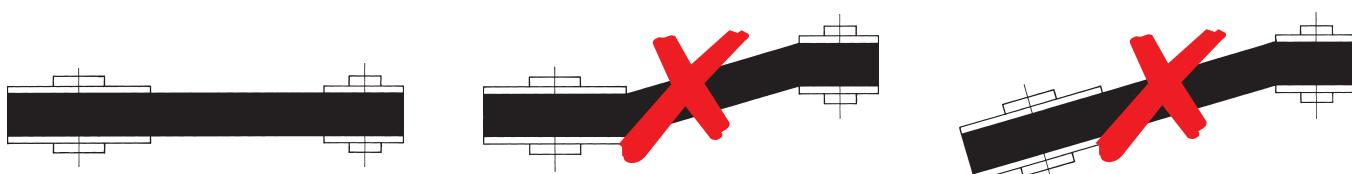
Соосные шкивы на валах с параллельными осями.
