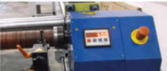
Automatische Spannung mit vier Voreinstellungen, großes digitales Display und Schneidepräzision auf 0,01 mm genau
