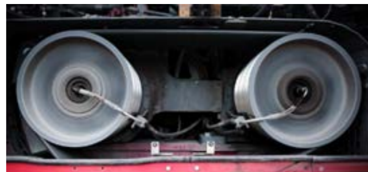
OPTIBELT Kraftbänder 5V KB treiben die beiden Motoren an
