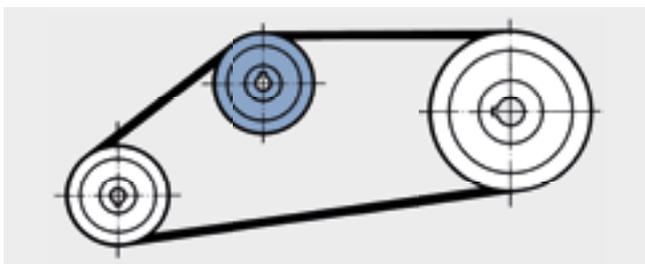
**Außenrollen** müssen grundsätzlich als Flachscheiben ausgeführt sein, da sie auf dem Rücken des Rippenbandes laufen. Sie vergrößern den Umschlingungswinkel. Es muss jedoch darauf geachtet werden, dass die maximal mögliche Riemen-
