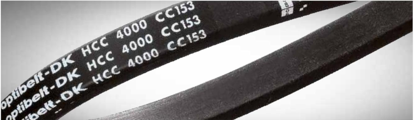
Durch den in der Profilmittte angeordneten Zugstrang ist der **optibelt DK** Doppelkeilriemen äußerst flexibel und dehnungsarm. Er eignet sich daher besonders gut für auftretende wechselseitige Biegung.
