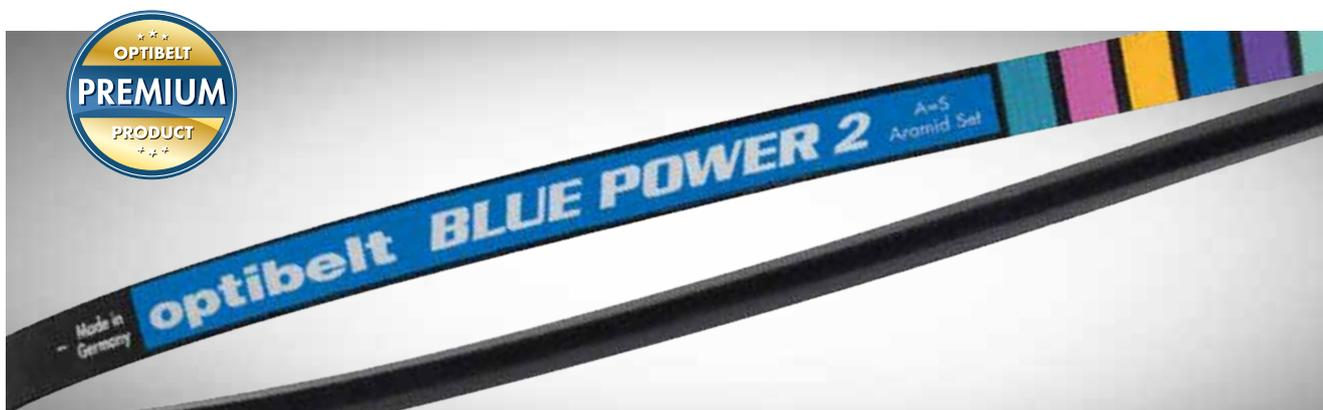
Der ummantelte Hochleistungs-Schmalkeilriemen **optibelt BLUE POWER 2** besitzt einen High-Flex Aramidzugstrang und eignet sich als Einzelriemen, im Satz oder als Kraftband besonders für große, sehr schwer belastete Antriebe.
