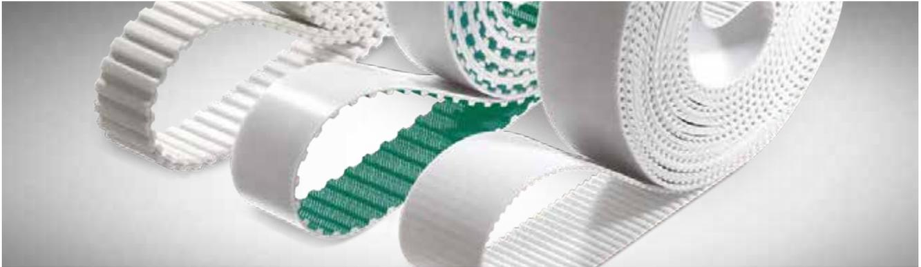
Der **optibelt ALPHA FLEX** Zahnriemen wird ohne Unterbrechung der Zugstränge endlos gefertigt; dies bedeutet, dass zwei schraubenförmig aufgewickelte Zugstränge zum Einsatz kommen. Durch eine optimale Kombination von extrem festen Zugsträngen und Polyurethan sind diese Zahnriemen für vielfältigste Anwendungen geeignet, wo eine hohe Leistung in Verbindung mit sehr großen Achsabständen übertragen werden muss.
