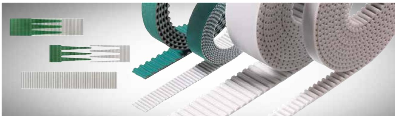
Die **optibelt ALPHA V** Zahnriemen werden aus endlich extrudierten **optibelt ALPHA LINEAR** Zahnriemen auf Länge verschweißt. Diese werden vorwiegend in der Transporttechnik verwendet.
