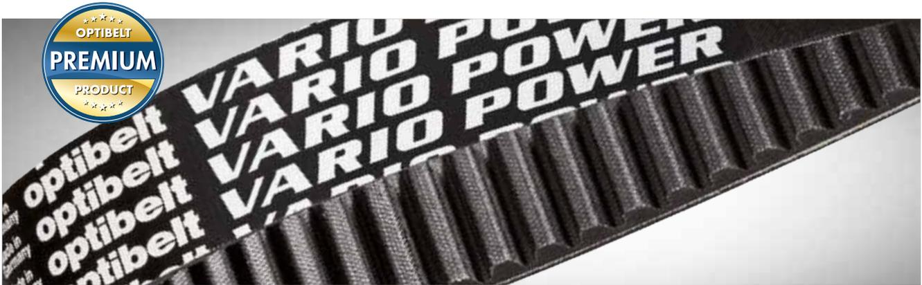
Der Riemenunterbau besteht aus einer Polychloropren-Gummimischung mit einer quer zur Laufrichtung eingebrachten Faserverstärkung. Der hochqualitative und äußerst dehnungsarme Zugstrang aus Polyester oder Aramid ist in einer Einbettmischung gefasst. Er wird verstärkt durch eine Gewebeauflage und bietet aufgrund der quer eingebrachten Fasern Quersteifigkeit, ohne dabei an Flexibilität zu verlieren.
