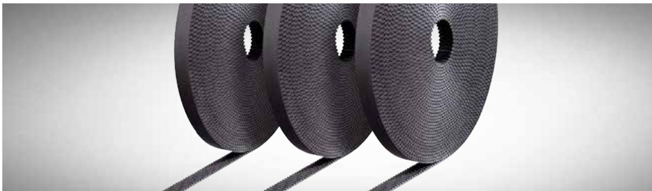
Die **optibelt OMEGA HP LINEAR** Zahnriemen aus Chloropren sind aus Wickeln im Spiralschnittverfahren (Spiral Cut) hergestellte endliche Zahnriemen mit Glascord.
