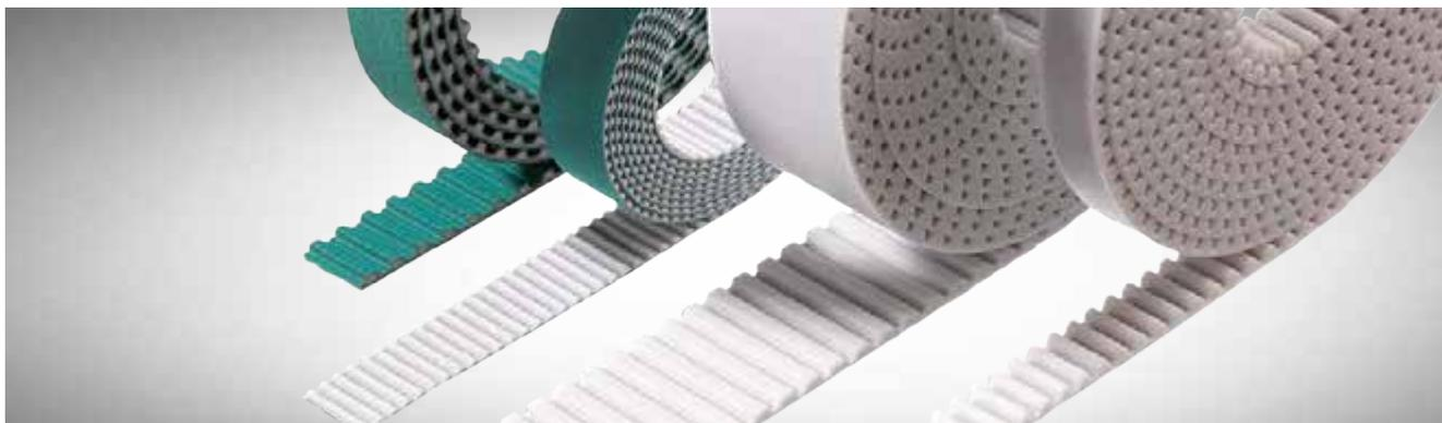
Der **optibelt ALPHA LINEAR** Zahnriemen kommt als endlicher Riemen mit großen Abmessungen überwiegend in linearen Antriebssystemen zum Einsatz. Der Aramid- oder Stahlzugstrang ist äußerst dehnungsarm. Die große Auswahl an Profilen und Längen erlaubt eine Fülle von Antriebslösungen.
