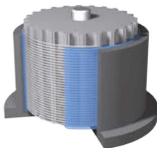
Procédé de fabrication par moulage pour courroies dentées
