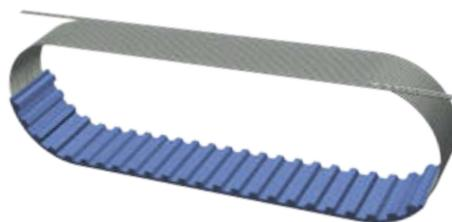
Structure de la courroie dentée **optibelt ALPHA FLEX** avec câble de traction S+Z enroulé hélicoïdalement et polyuréthane formé extrudé
