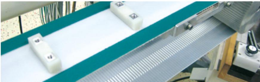
Contrairement aux revêtements travaillant par adhérence, les tasseaux permettent un déplacement synchronisé des pièces et servent par exemple à :
