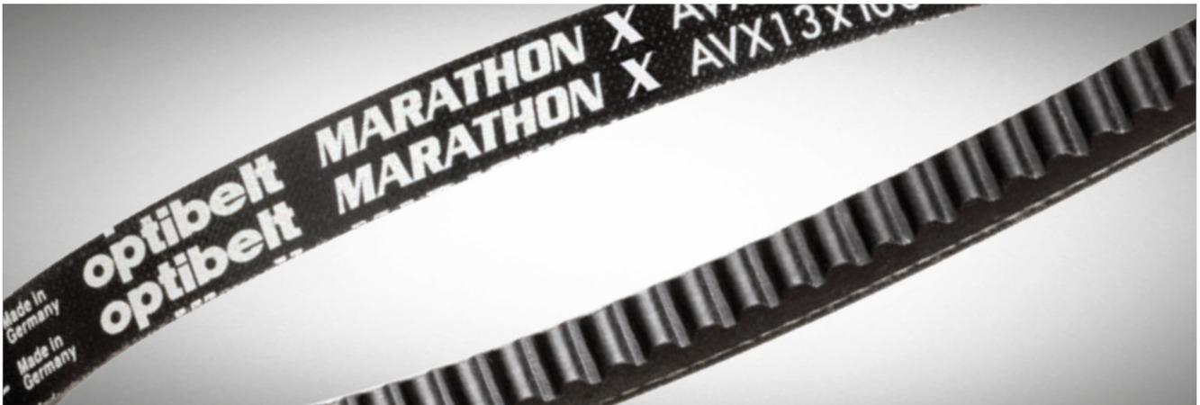
La **optibelt MARATHON X** ha sido diseñada para accionar componentes auxiliares de motores de turismos y de vehículos industriales ligeros. Esta correa trapecial con flancos abiertos y dentada se caracteriza por su larga vida útil y por un comportamiento bajo tensión de baja elongación. La correa se fabrica con EPDM resistente a la temperatura (desde -40 hasta +120 °C).
