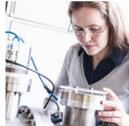
Bild links: Vorbereitung einer Probe, die in einer Vakuumkammer bedampft wird, um eine leitende Oberfläche herzustellen.
