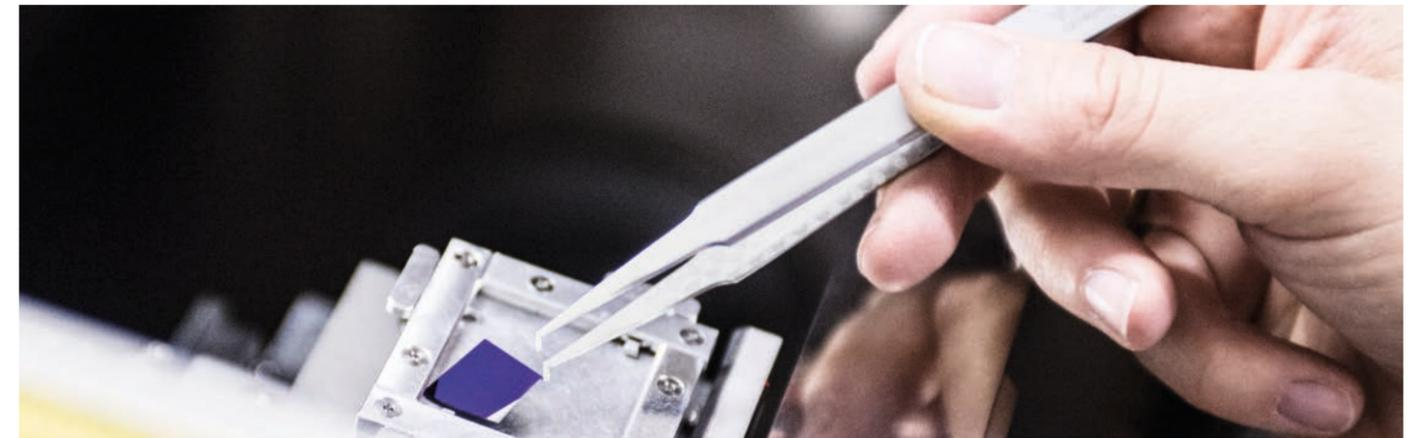
Bild oben: Einbau einer Probe in das Rasterelektronenmikroskop (REM).
