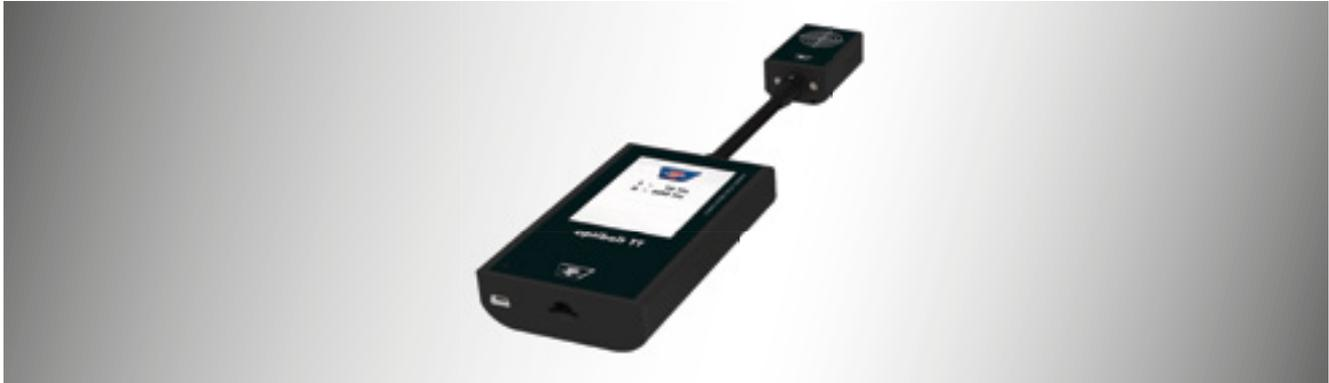
Das optibelt TT Frequenz-Messgerät dient zur Vorspannungsüberprüfung von Antriebsriemen durch Frequenzmessung. Es bietet durch seine kompakte Bauform universelle Einsatzmöglichkeiten für Antriebe im Maschinenbau, in der Kfz-Industrie und für viele weitere technische Anwendungen.
