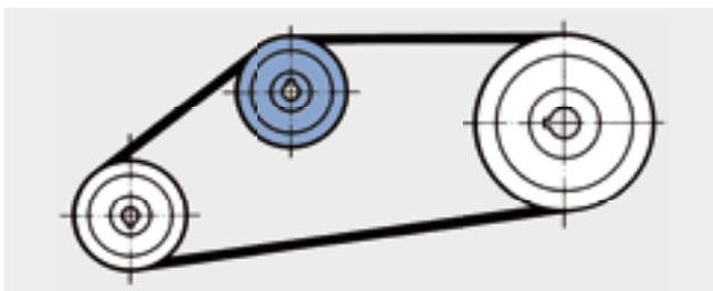
**Außenrollen** müssen grundsätzlich als Flachscheiben ausgeführt sein, da sie auf dem Rücken des Keilrippenriemens laufen. Sie vergrößern den Umschlingungswinkel. Es muss jedoch darauf geachtet werden, dass die maximal mögliche Riemen-
