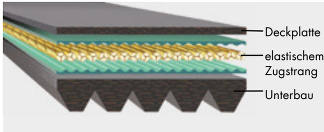
Der elastische Keilrippenriemen zeichnet sich u. a. aufgrund der sehr individuellen Auslegungs- und Anpassungsmöglichkeiten für unterschiedlichste Antriebslösungen speziell bei festen Achsabständen aus.
